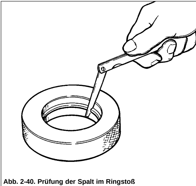
Abb. 2-40. Prüfung der Spalt im Ringstoß
